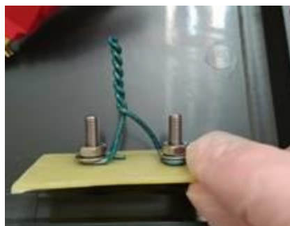
Рисунок 3. Образец после химической обработки аммиаком 5%
